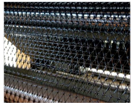
. Трехосноориентированные георешетки предназначены для применения в качестве армирующей и разделяющей прослойки в конструкциях линейных транспортных сооружений (автомобильных в соответствии с СП 34.13330.2012, трубопроводных и других геотехнических сооружениях).
